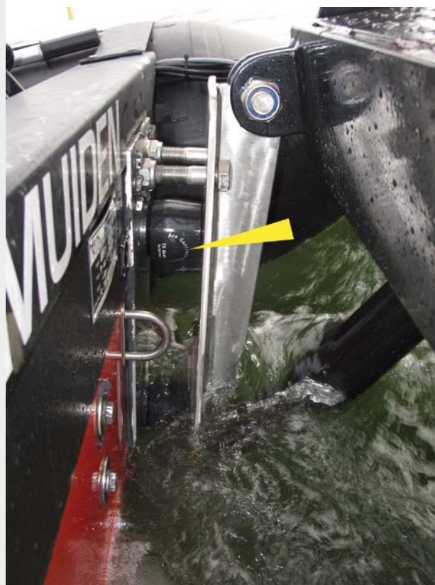
Zeewaterbestendige, robuuste TUBUS-structuurdempers van copolyester elastomeer zorgen ervoor dat boten en bemanning veilig kunnen aanmeren Wals Diving and marine service, 1970AC IJmuiden, Nederland
