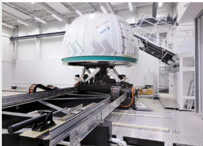
ACE veiligheidsstootdempers beschermen eindstanden van een rijnsimulator in twee assen Bosch Rexroth B. V., 5281 RV Boxtel, Nederland en Universiteit van Stuttgart - FKFS, 70569 Stuttgart, Duitsland
